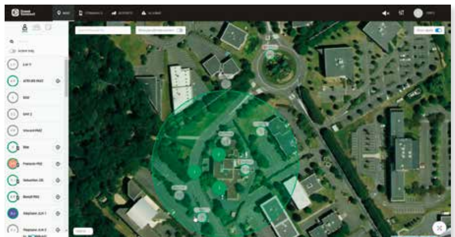
Exemple de Geofencing activé : définition d'un périmètre de surveillance renforcée (cercle vert, 3 utilisateurs)
