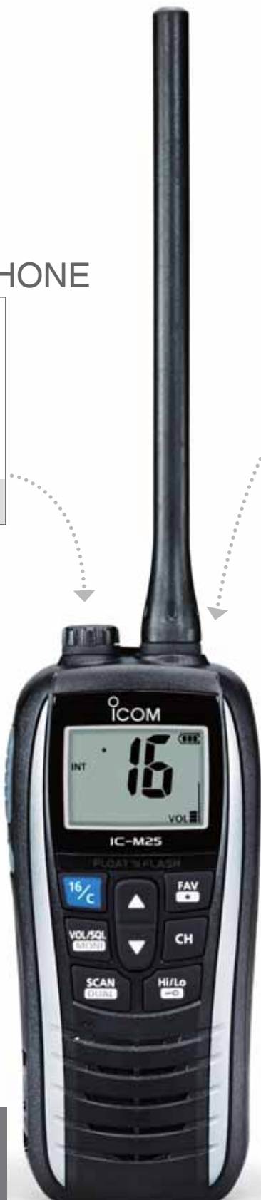
Microphone haut-parleur étanchéité IP67
