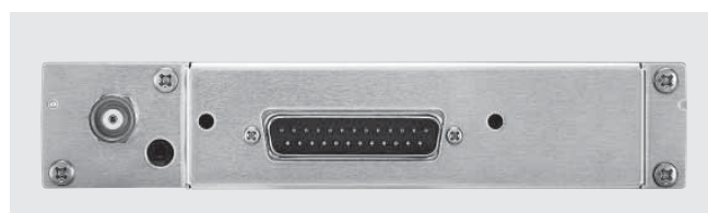
Face arrière avec connecteur D-SUB 25-pin
