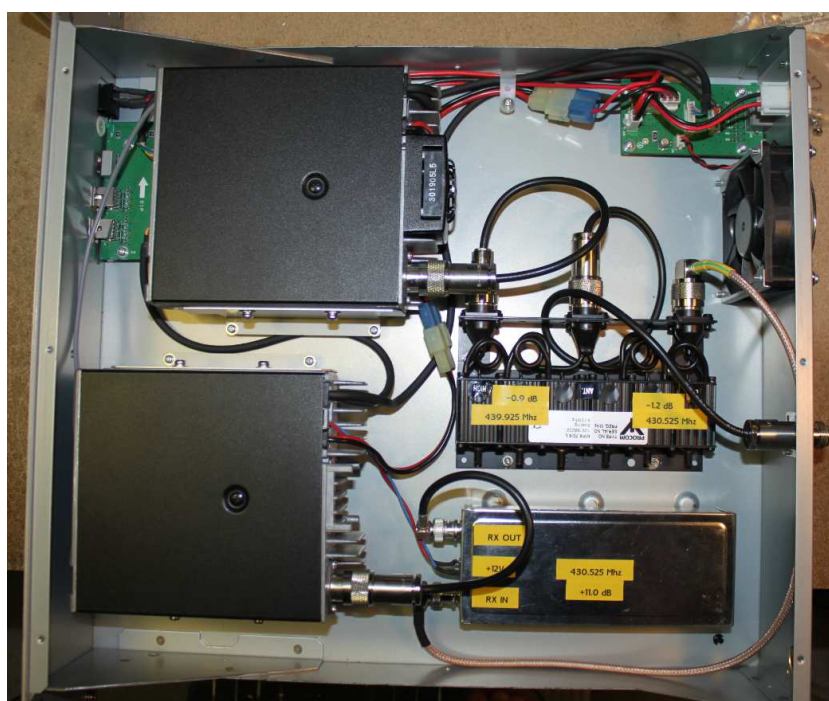
Module radio ID-RP4000V – F5ZLG, équipé de son duplexeur et de son « filtre-préampli »
