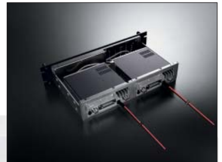
Le relais permet l'installation simultanée de deux modules pour bénéficier de 2 canaux
