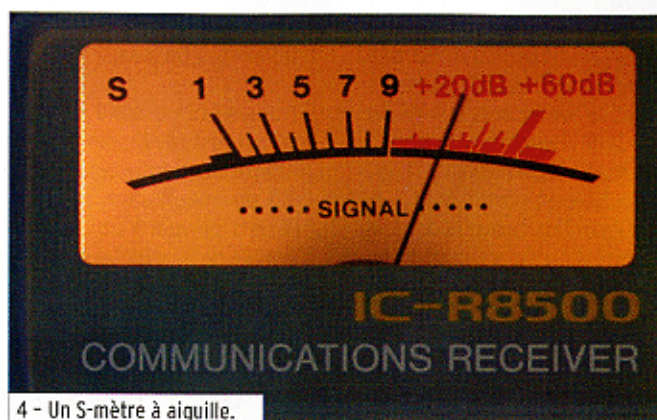
4 - Un S-mètre à aiguille.
