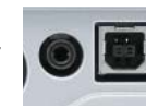
Jack de télécommande CI-V (à gauche) et connecteur USB sur la face arrière ▲
